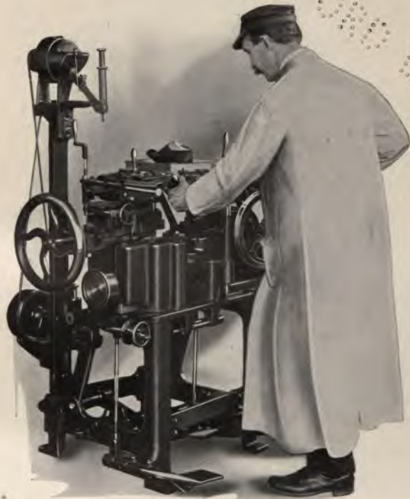
Operating the U. S. M. Co. Lasting Machine
